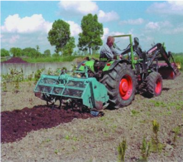
Figuur 1-12: In de tuinbouw bewerk je grote stukken met een spitmachine.
